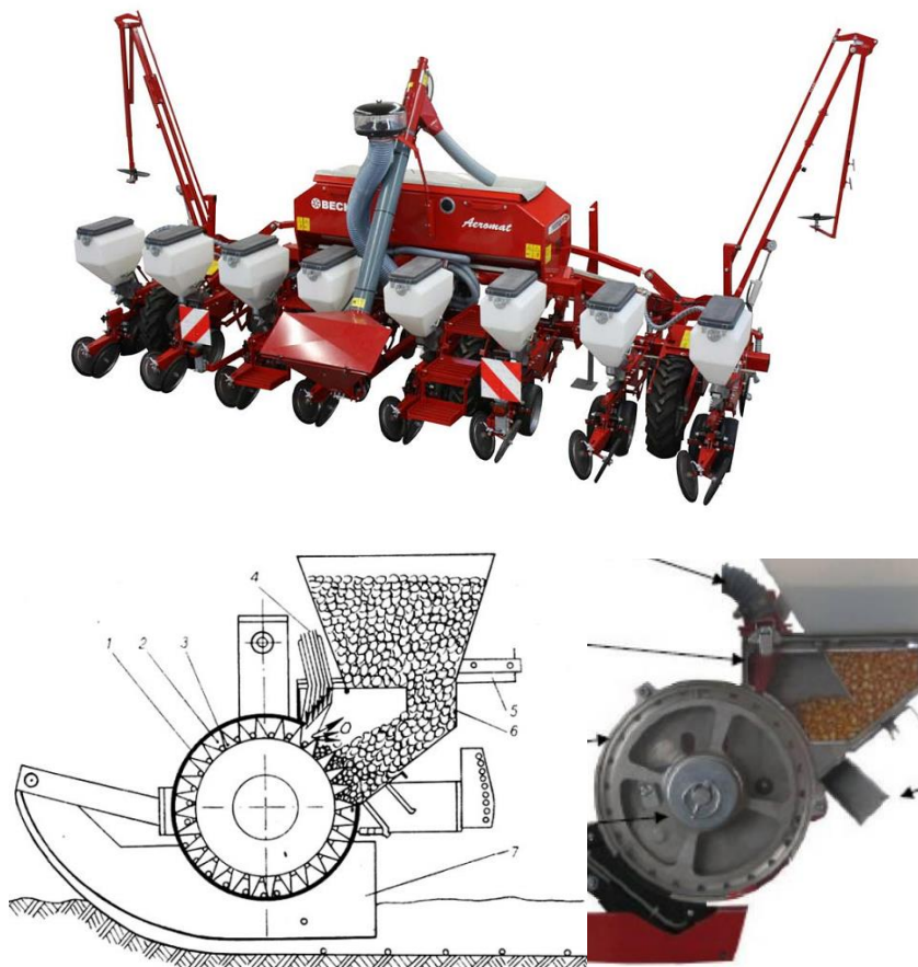
Рис. 3.6. Загальний вигляд та схема висівного апарата сівалки «Аеромат» [33]: 1 – кожух, 2 – комірка диска, 3 – дозуючий диск, 4 – сопло, 5 – заслінка, 6 – насіннєвий бункер, 7 – сошник.
