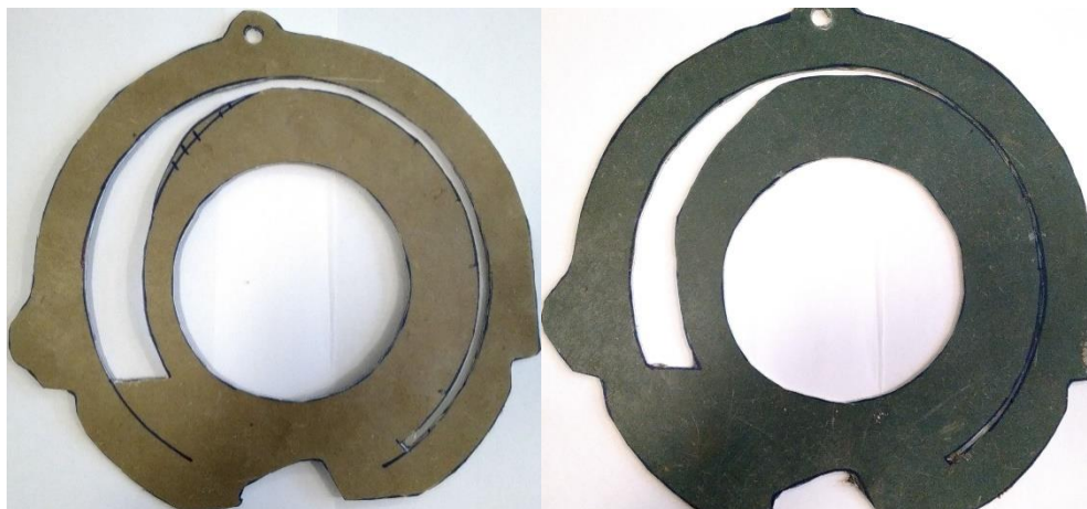
Рис. 3.12. Загальний вигляд модернізованої прокладки з різною мінімальною шириною щілини
