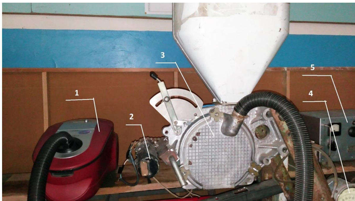
Рис. 3.9. Загальний вигляд лабораторної установки: 1 – пилосмок «VCC4140V38»; 2 – кроковий електромотор; 3 – досліджуваний висівний апарат; 4 – манометр; 5 – випрямляч струму ВСА-111К.
