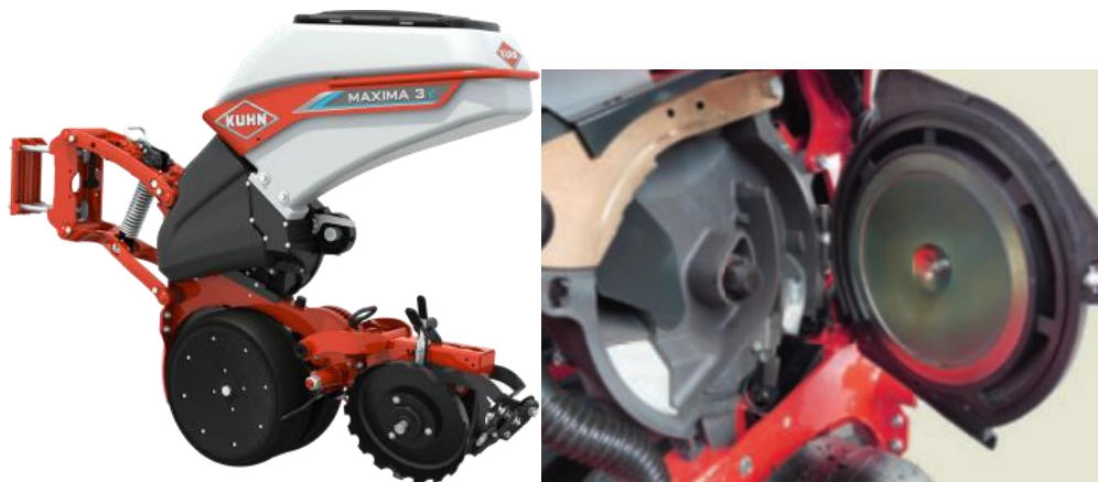
Рис. 3.2. Посівна секція сівалки MAXIMA 3 фірми Kuhn [35].
