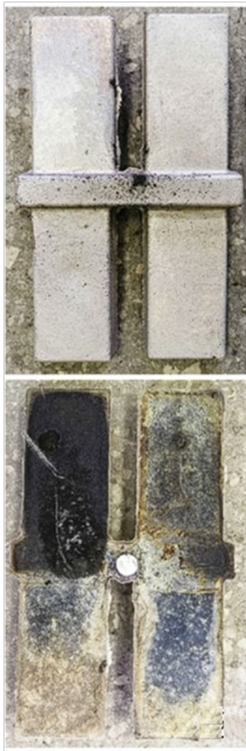
Рисунок 3.6 – Зразки на пористість зі сплавів МЛ10 (а), МЛ 12 (б)
