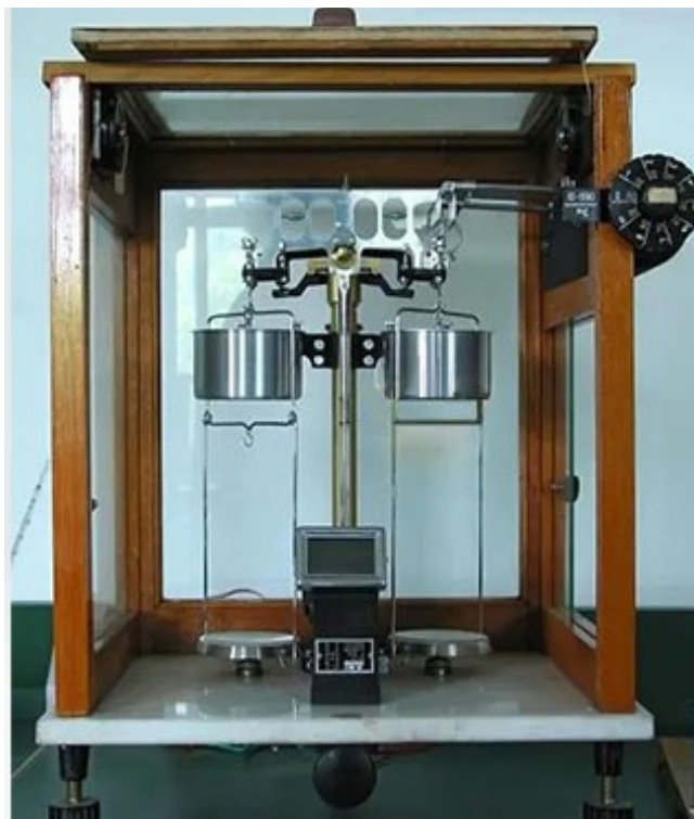
Рисунок 2.3 – Загальний вид аналітичних ваг
