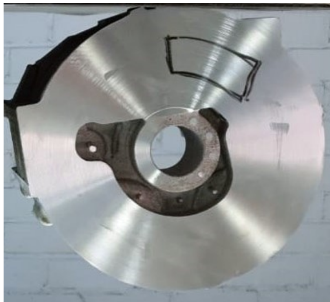
Рисунок 3.1 - Експериментальні виливки «Корпус насоса» із сплаву МЛ 10 після випробувань на гідроущільність.
