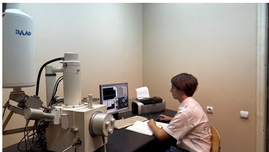
Рисунок 2.1 – Скануючий електронний мікроскоп РЕМ-106
