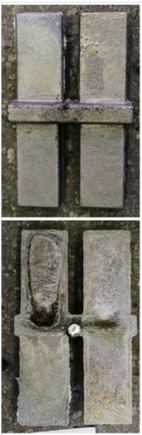
Рисунок 3.6 – Зразки на пористість зі сплавів МЛ10 (а), МЛ 12 (б)
