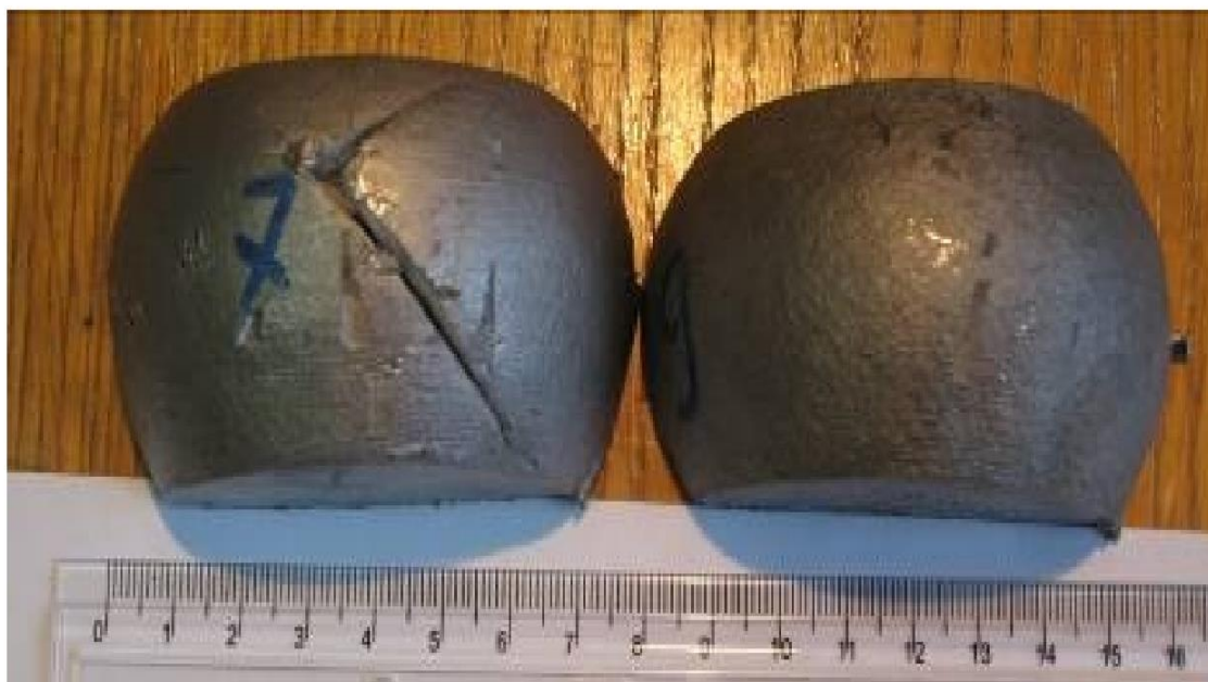
Рис. 3.10 – Зовнішній вигляд бокових поверхонь деформованих зразків: зліва – зразок, отриманий із вихідного (нерафінованого) металу; зправа – зразок, отриманий із рафінованого металу (продувка аргоном і фільтрація в МДУ).
