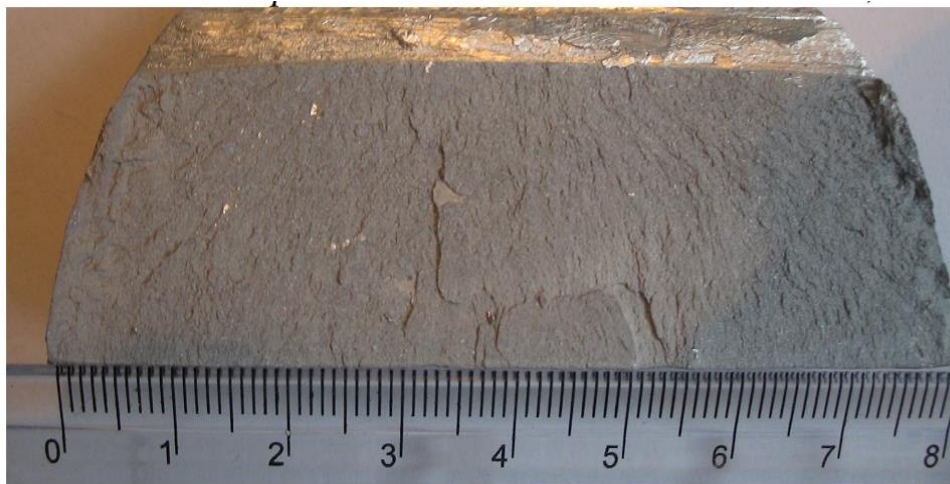
Рис. 3.12 – Злом зразка, отриманого із металу після рафінування в МДУ з одночасним фільтруванням через пінокерамічний фільтр і продувкою аргоном на протязі 20 хв та відстоюванням в режимі зберігання на протязі 20 хв без видалення фільтра – показник вмісту неметалевих домішок 0,08%
