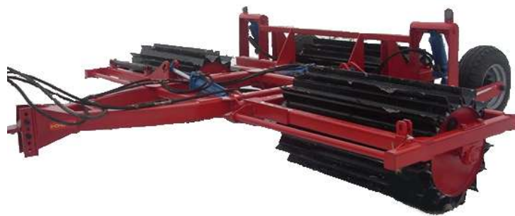
Рис.2.4. Коток-мульчувач рослинних залишків КП-4,5
