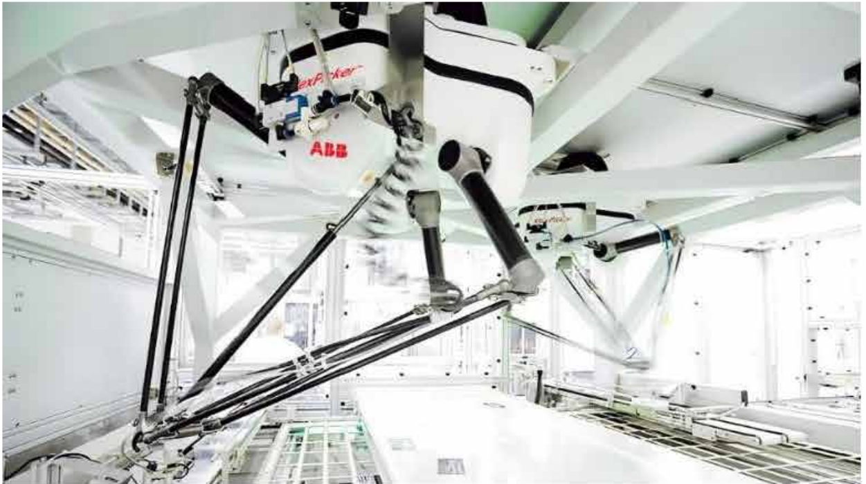
Рис. 1.4 Система ABB FlexPicker з використанням дельта-структури паралельної кінематики
