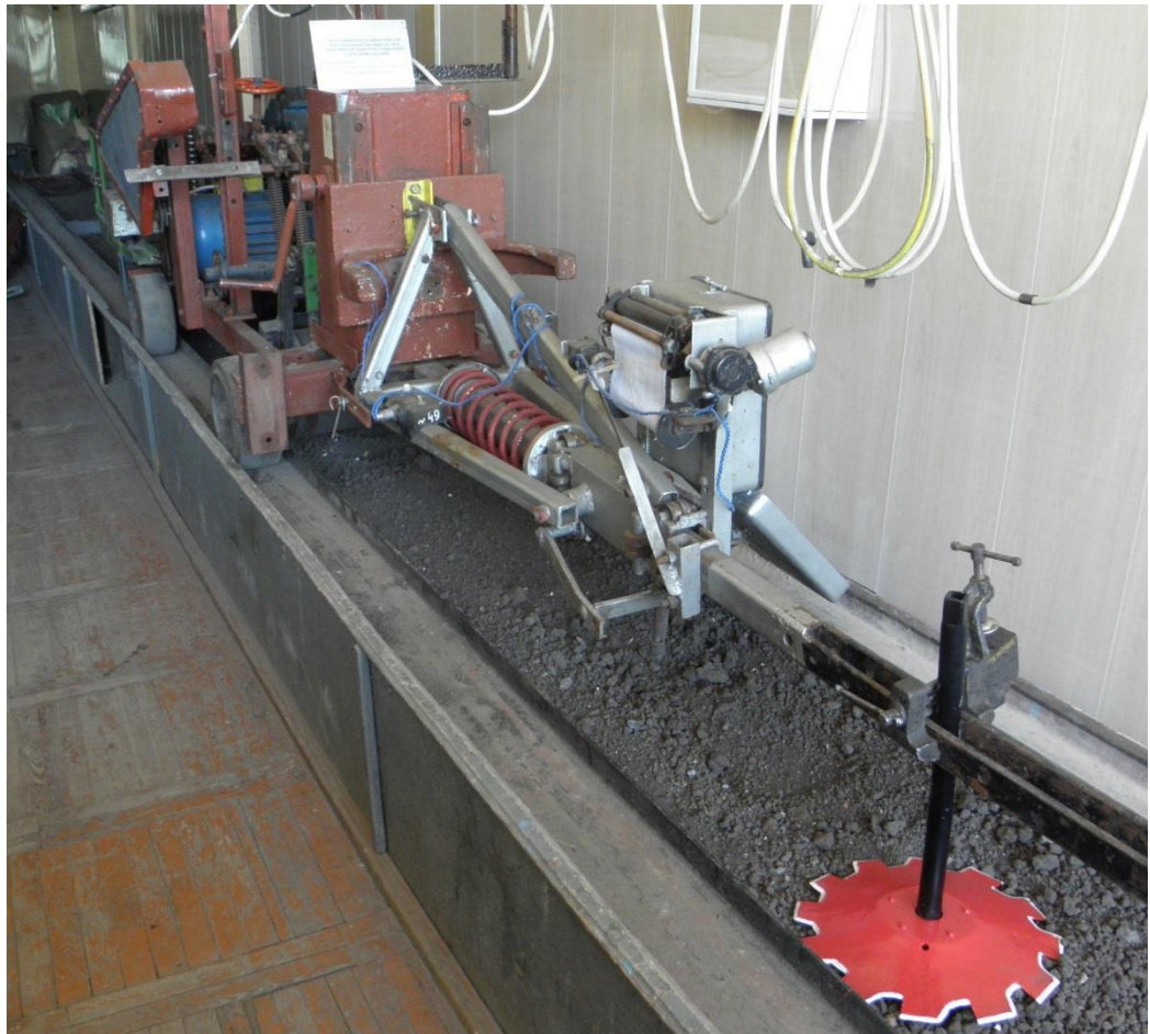
Рис. 3.12. Загальний вигляд лабораторної установки для дослідження параметрів функціонування дискової культиваторної лапи.
