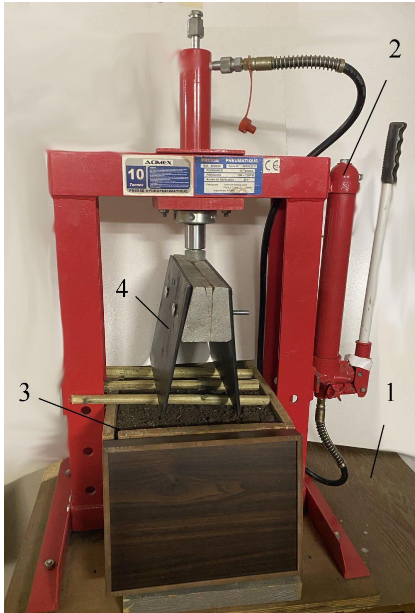
Рис.3.3. Загальний вигляд стану для визначення ймовірності забивання міжножового простору частинками подрібнених стебел соняшнику: 1 – станина; 2 – гідравлічний прес; 3 – фрагмент ножового барабана; 4 – ємкість з ґрунтом.
