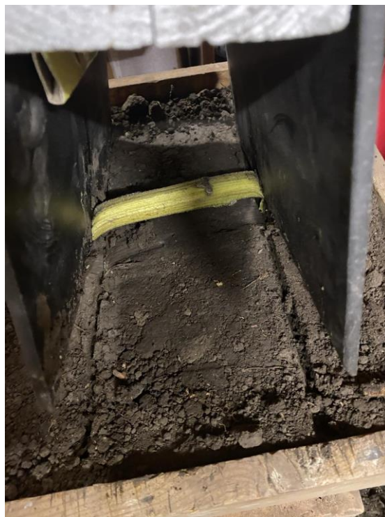
Рис.3.6. Затискання стебел між ножами
