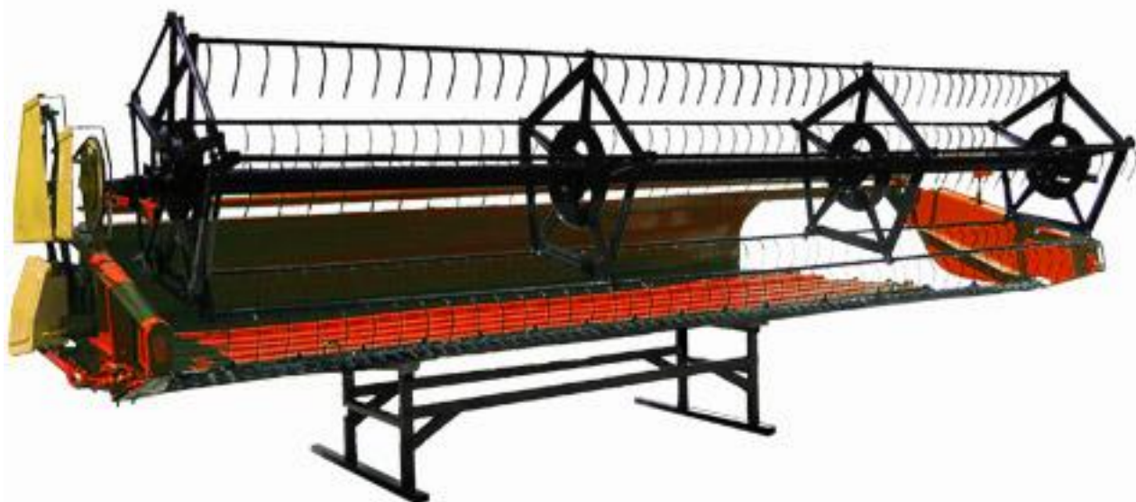
Рисунок 2.5 – Жатка валкова навісна ЖВН-6Б
