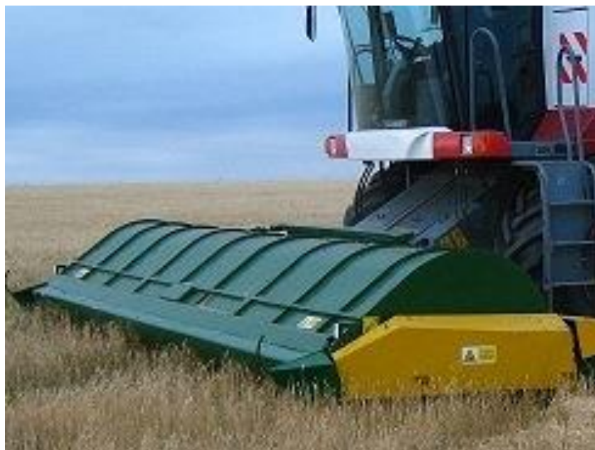
Рисунок 2.4 – Очісуюча жатка «Слав'янка»
