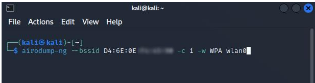
Рисунок 7.6 – Запуск airodump-ng для запису трафіку, пов’язаного з даною точкою доступу
