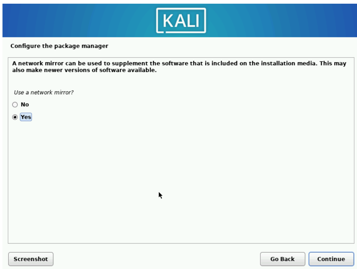
Рисунок 1.13 – Оберіть “Yes” для використання мережі для оновлення ПЗ, що встановлюється, одразу під час інсталяції
