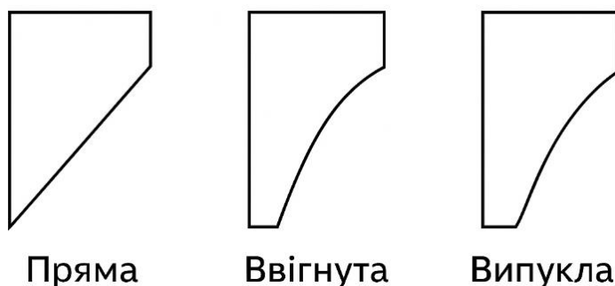
Рисунок 2 – Варіанти геометрії ріжучої крайки ножа
