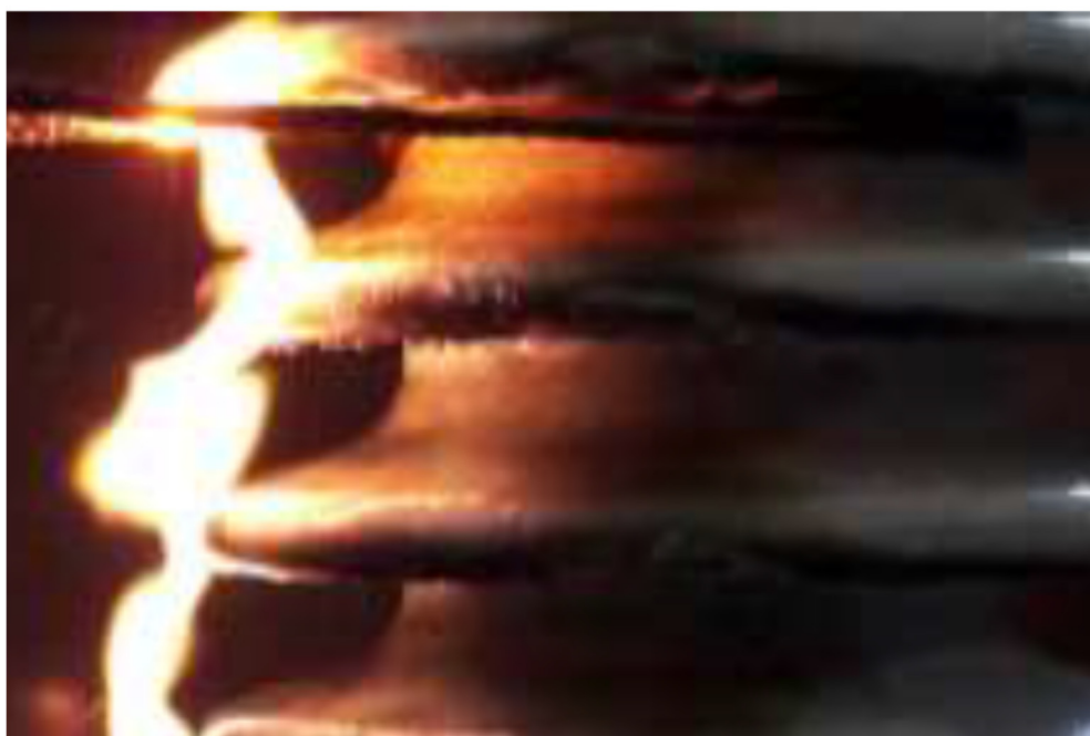
Рисунок 1.7. Формування струмопровідного каналу на ізоляторі із часткових дуг
