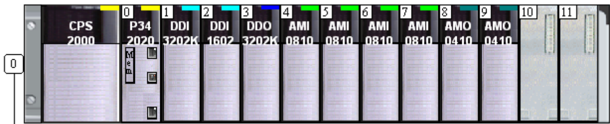
Рисунок 3.1 – Структурна схема програмованого логічного контролера, призначеного для виконання функцій автоматичного керування конвеєрною лінією СК-2 під час роботи в умовах скельного тракту
