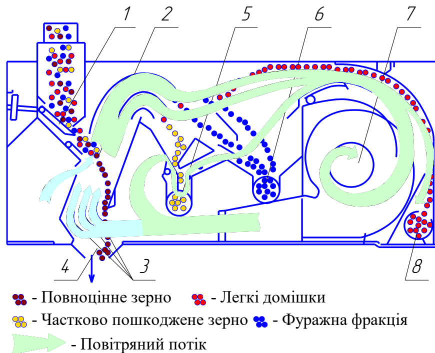
Рис. 14. Схема повітряної системи ЗОМ К-560 «Petkus»:
