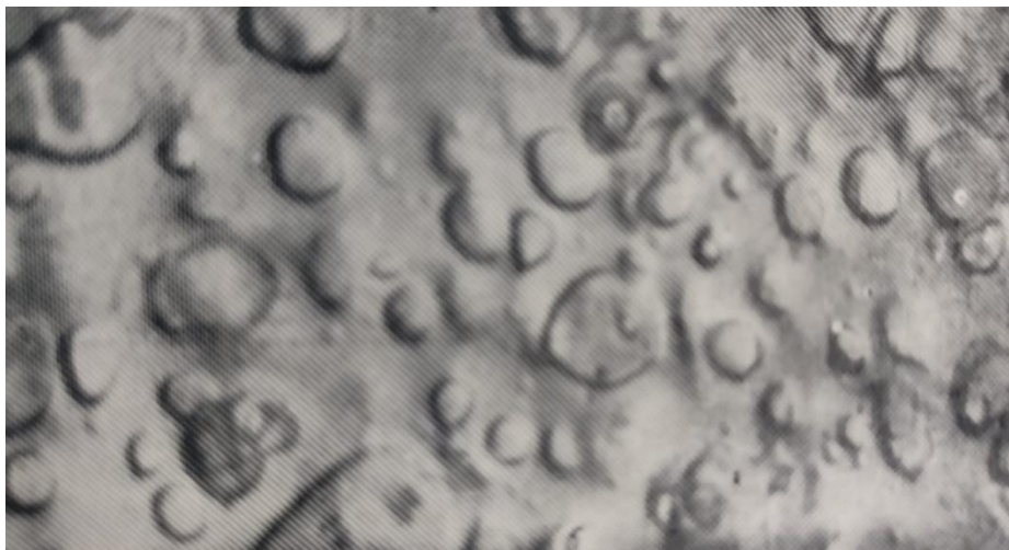
Рис. 3.1. Вплив модифікування на форму карбідів а) – первинних, X 7000; б) – вторинних, X 5000
