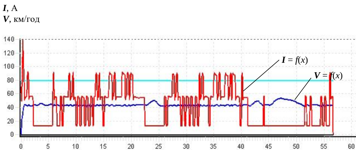
Рисунок 2.5. Тягові характеристики поїзда 1200 т для непарного напрямку
