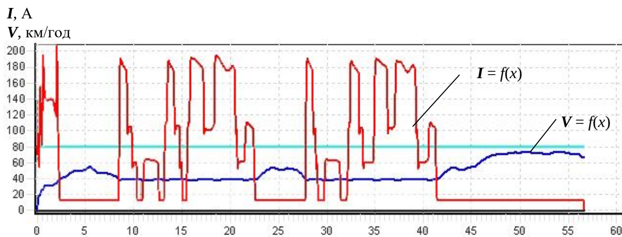
Рис. 2.3. Визначення тяги поїзда 5000 т для непарного напрямку
