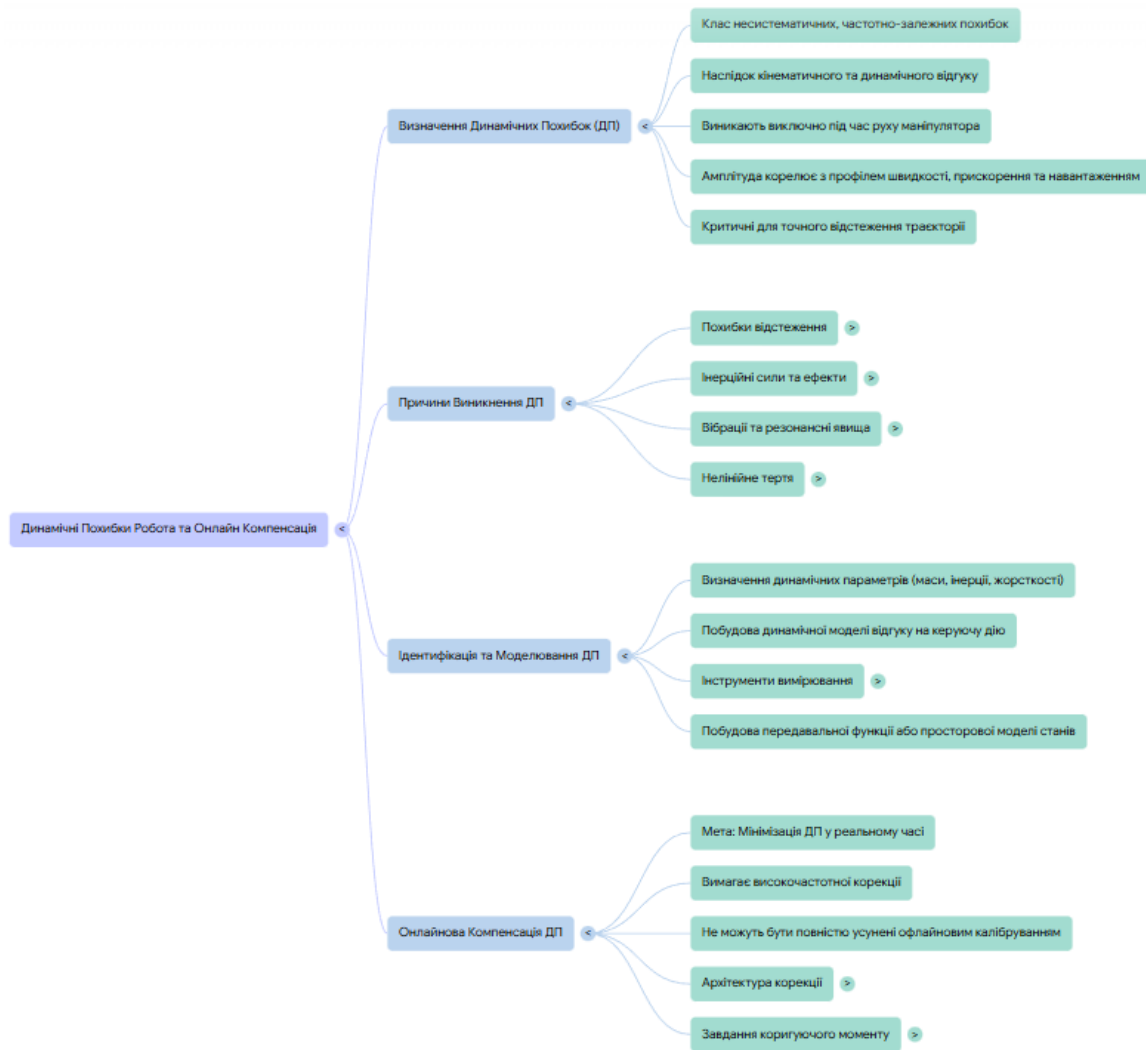
Рисунок 1.3 – Динамічні похибки промислових роботів та онлайн компенсація
