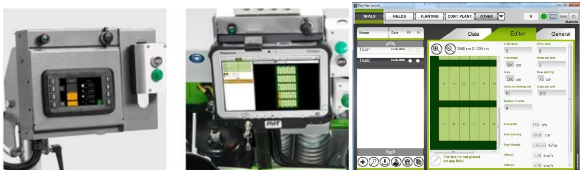
Рис. 2.2 – Система eMotion керування селекційною сівалкою Row Motion
