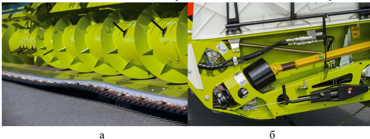
Рис. 4.10 – Гнучкий ножовий брус жатки «Maxflex Claas» (а) та привод ножового бруса «Claas Convio Flex» (б) [4, 6]
