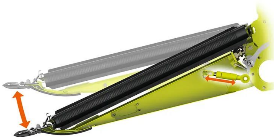
Рис. 4.3 – Гідропневматичний розвантажувач ACTIVE FLOAT «Claas» [4]
