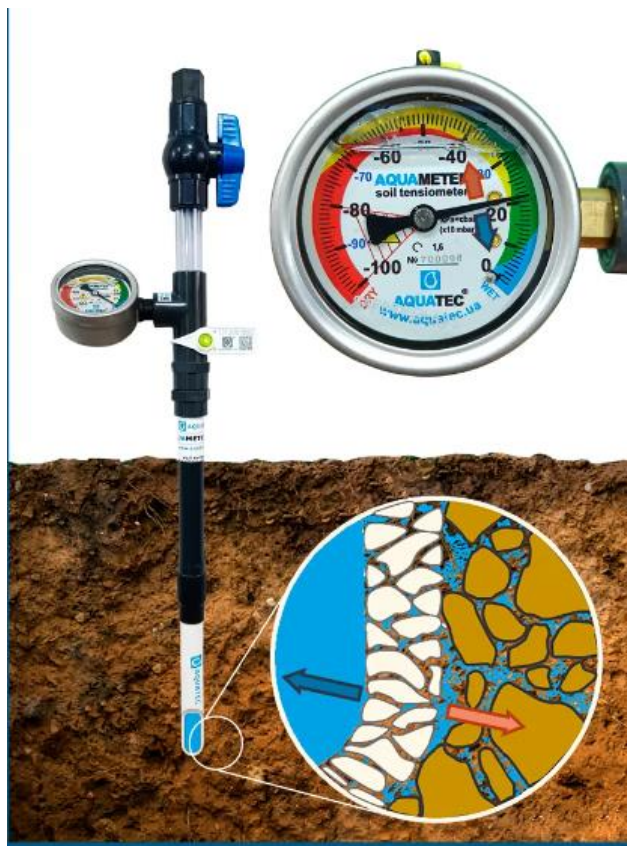
Рис. 1.7 – Принцип дії тензіометра [3]
