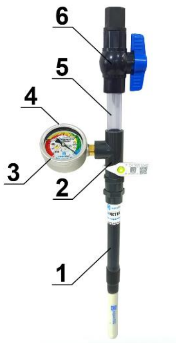
Рис. 1.6 – Тензіометр AQUATEC іригаційний, серія AQUAMETER PRO, модель T GL [3]: 1 – труба з керамічним зондом; 2 – корпус; 3 – механічний вакуумметр; 4 – вентиляційний клапан; 5 – оглядова ділянка; 6 – кран-засувка з кришкою
