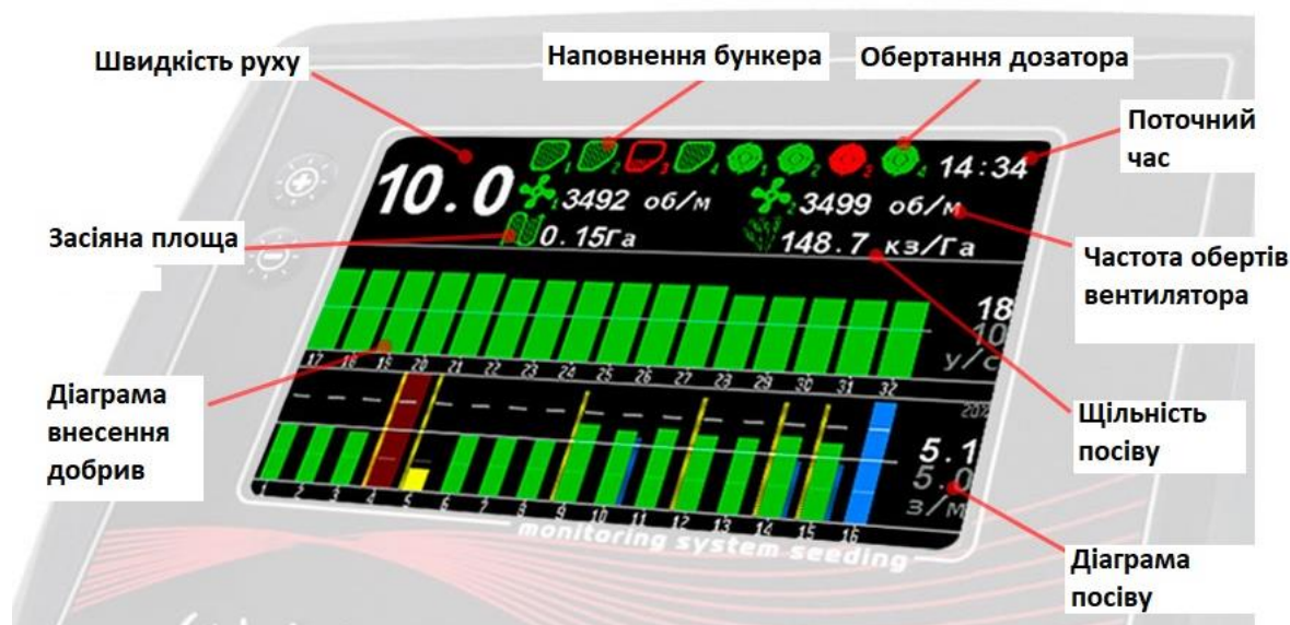
Рис. 2.12 – Загальний вигляд панелі оператора і відображення даних системи контролю висіву на базі Monada Helios-04 [5]
