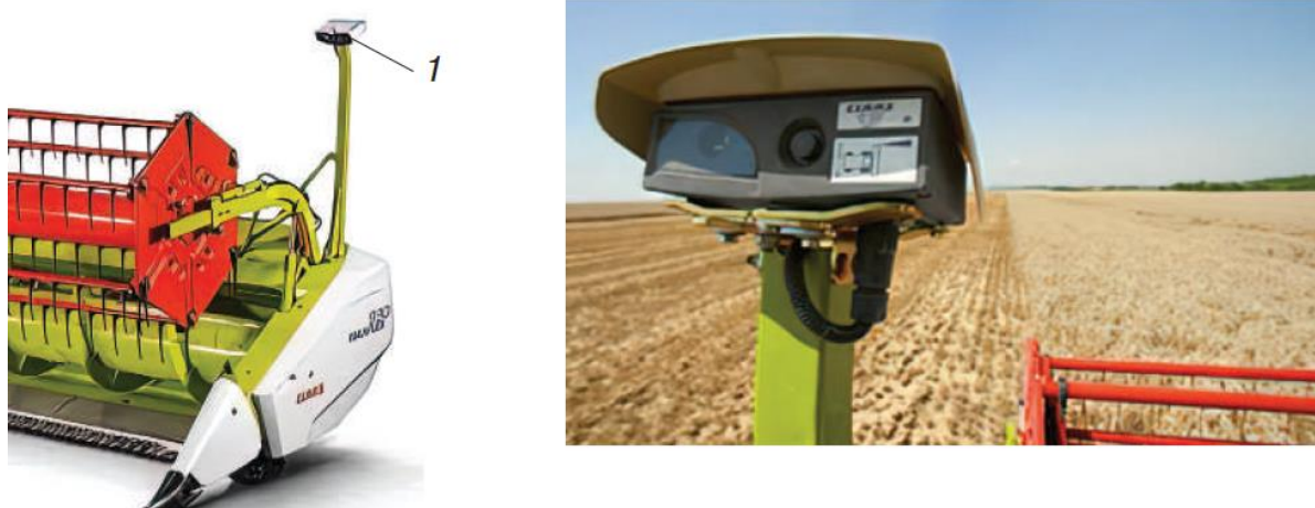
Рис. 4.8 – Розміщення датчиків (1) системи «Laser Pilot» на жатці комбайна «Claas» [4]
