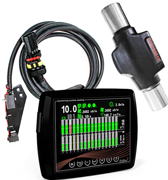
Рис. 2.11 – Загальний вигляд системи контролю висіву на базі Monada Helios-04 [5]
