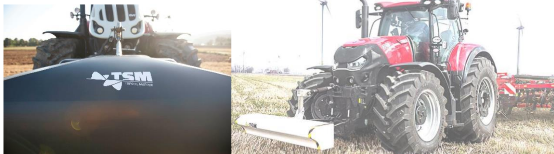
Рис. 3.6 – Пристрій Topsoil Mapper з датчиками визначення характеристик ґрунту [5]
