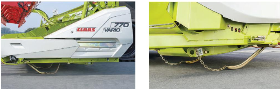
Рис. 4.4 – Датчики-копіри системи ACTIVE FLOAT «Claas» [4]
