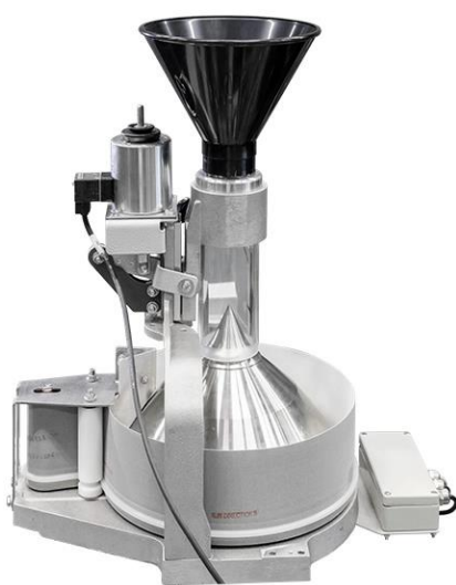
Рис. 2.3 – Конічний дозатор точного розподілення насіння по рядкам
