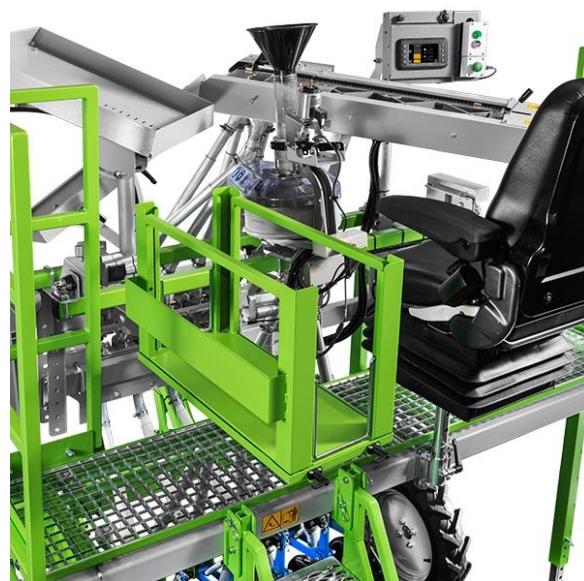
Рис. 2.3 – Конічний дозатор точного розподілення насіння по рядкам
