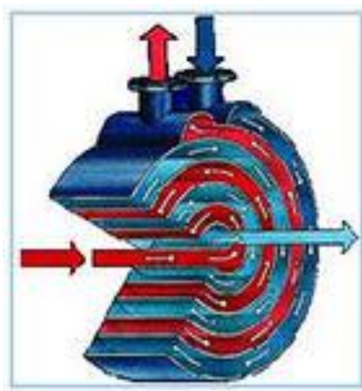
Рис. 1.5. Напрямок потоків в спіральному теплообміннику.
