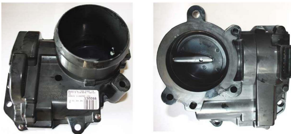
Рисунок 6.3 - Зовнішній вигляд дросельної заслінки 40624.1148090 VDO(SIEMENS)
