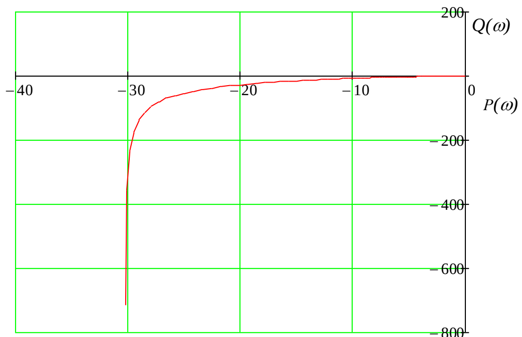
Рисунок 3.1 – Амплітудно-фазова частотна характеристика розімкнутої системи
