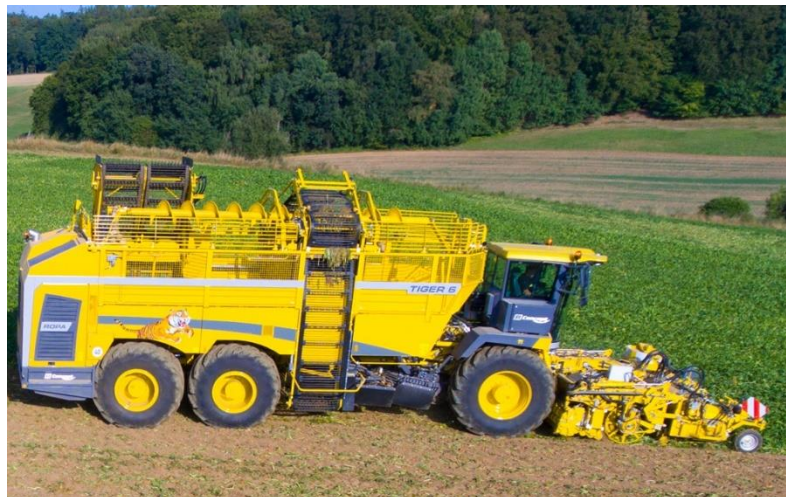
Рис. 2.5. Буярозбиральний комбайн Tiger 6S, ROPA
