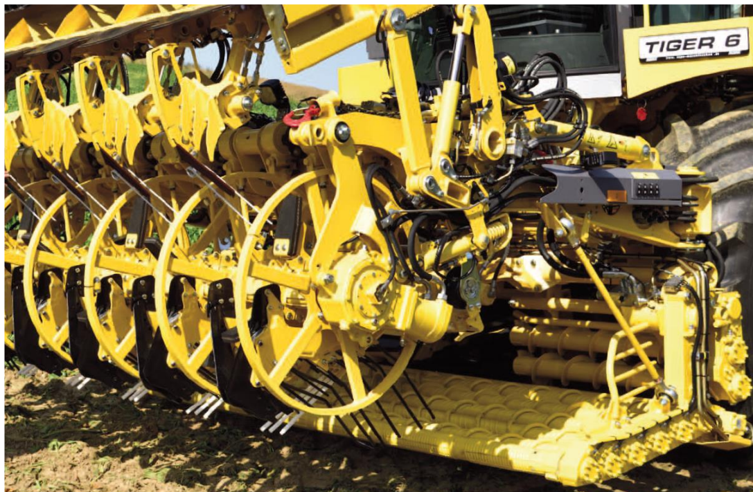
Рис. 2.6. RR-копач комбайна Tiger 6, ROPA
