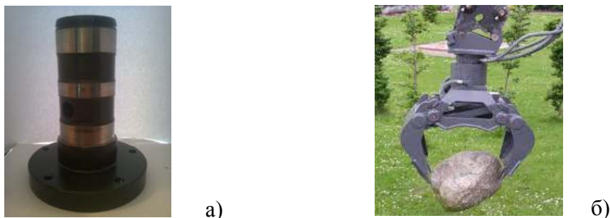
Рисунок 6 – Відновлені поверхні поршня (який новим був анодованим) (а) та загальний вигляд (б) ротатора грейфера методом електродугового напилення із порошкового дроту ФМІ-2
