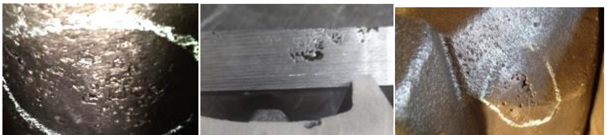
Рисунок 3 – Типові дефекти сталевих виливків
