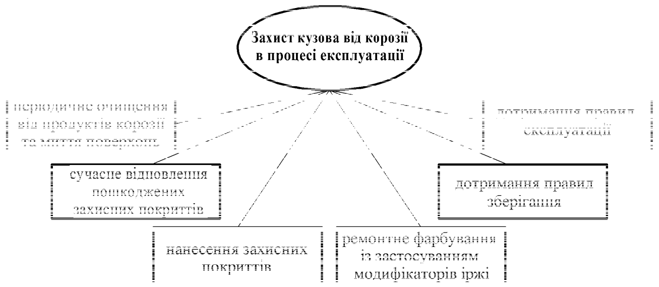
Рис.2.8. Класифікація способів захисту кузова легкового автомобіля під час експлуатації
