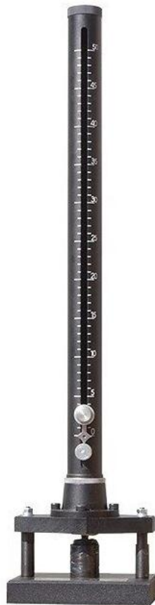
Рис.3.7. Прилад типу У-1 «Константа У1А»
