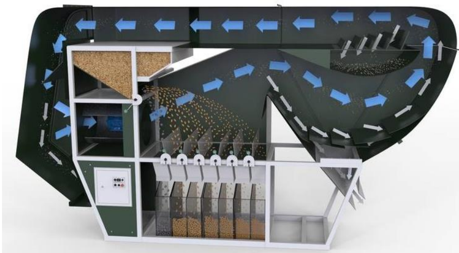
Рис. 2.1. Загальний вигляд пневмосистеми в розрізі сепаратора ІСМ [7]
