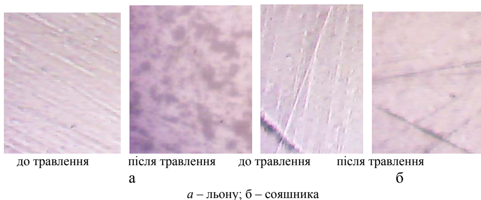
Рисунок 5 – Мікроструктура зразка голки до і після травлення в олії
