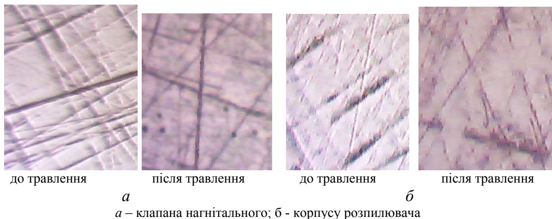
Рисунок 3 – Мікроструктура зразків до і після травлення в рапсовій олії
