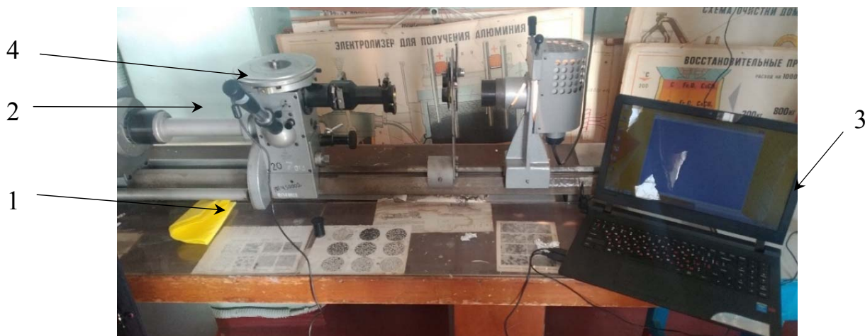
1 – металографічний мікроскоп МИМ-8; 2 – цифровий монокуляр Bresser; 3 – мобільний ПК для отримання та зберігання мікрофотографій; 4 – дослідний зразок
