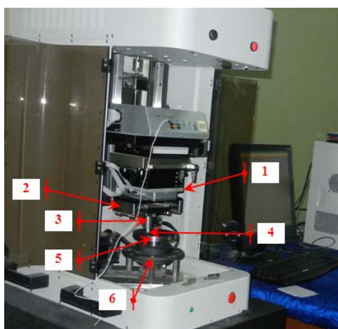
1 – двойной сенсор для силы трения и нагрузки; 2 – система подвески; 3 – фиксатор штифта; 4 – штифт; 5 – диск; 6 – стол–опора для диска
