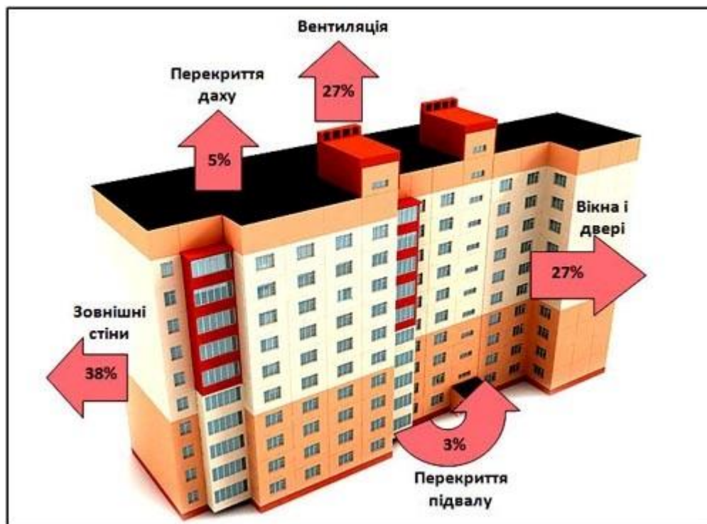
Рисунок 1.1 – Втрати тепла в традиційних багатоповерхівках.
