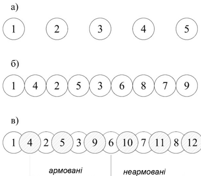
Рисунок 4 – Стіни з переривчастим розташуванням паль
