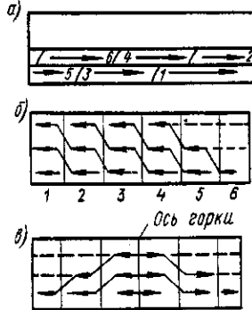
а – зварювання способом подвійного шару; б – зварювання каскадом; в – зварювання гіркою
