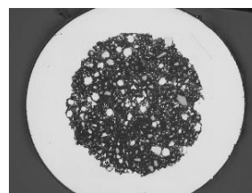
Рисунок 1 - Поперечний переріз порошкових дротів діаметром 1,6 (а) та 2,4 (б) мм
