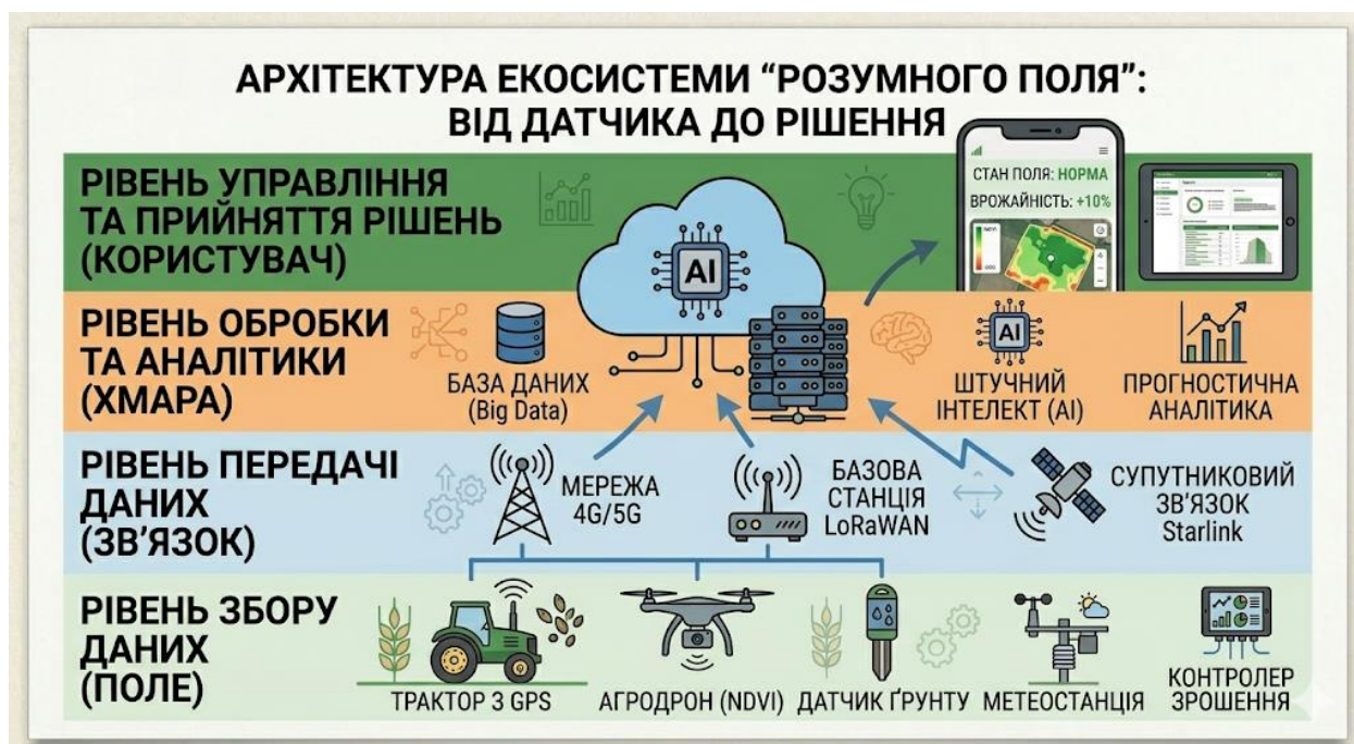
Рисунок 1.4 – Архітектура екосистеми «Розумного поля»: від датчика до рішення
