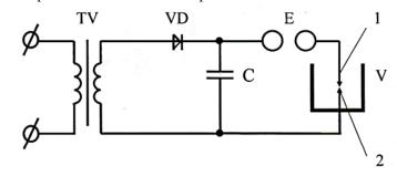
TV – трансформатор поднятия напряжения; VD –выпрямитель; С – конденсатор; V – резервуар с жтдкостью; Е – разрядник с искрой; 1, 2 – электроды
