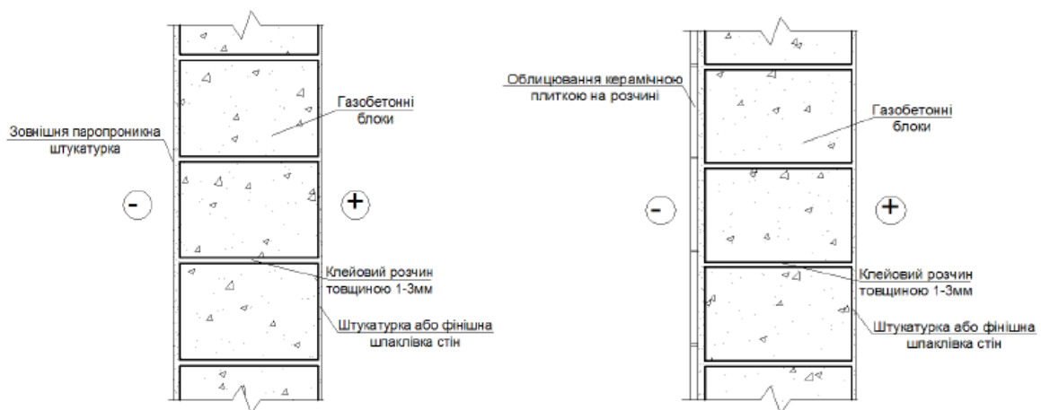
Рис. 1.4 Схеми суцільних одношарових стін з блоків ніздрюватого бетону
