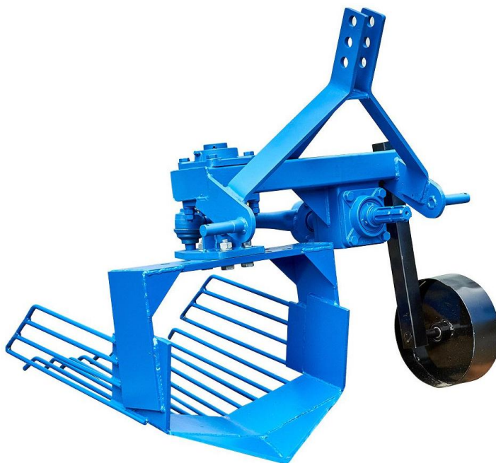
Рис. 2.10. Картоплекопач вібраційний ДТЗ-1В
