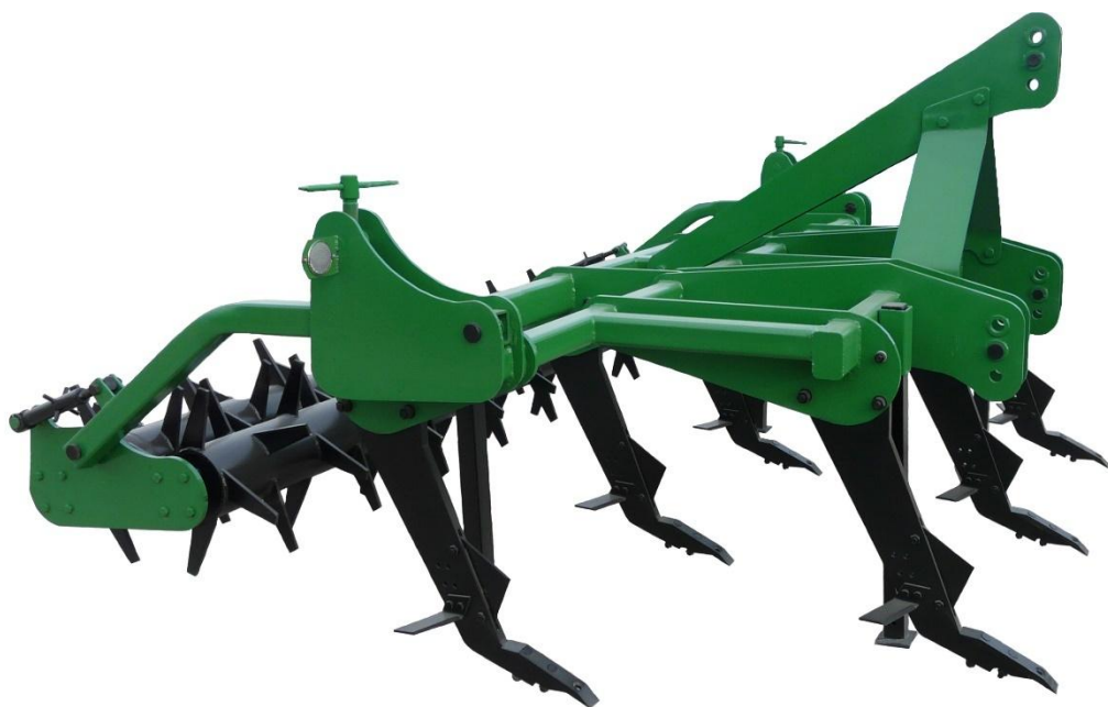
Рис. 5. Загальний вигляд комбінованого навісного чизеля ЧН-3,5
