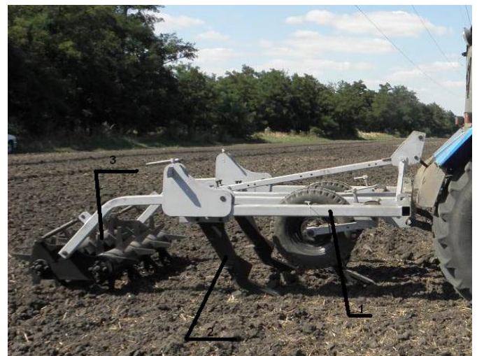
Рис. 10. Експериментальний чизельний комбінований ґрунтообробний агрегат:
