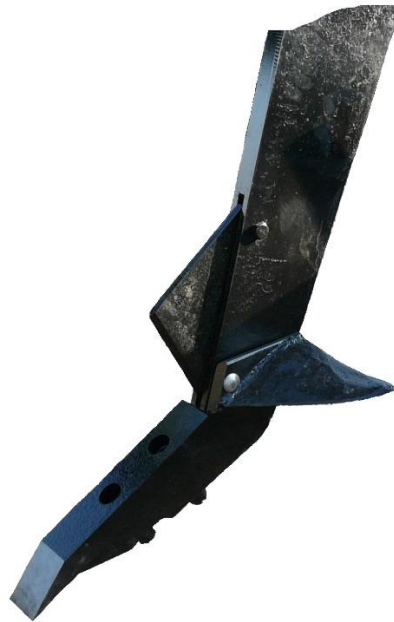
Рис. 6. Конструкція чизельної лапи із зубом долотом та обтічними крилами на прямому стояку
