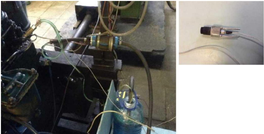
Рисунок 2.4 - П'єзоелектричний датчик тиску із системою охолодження
