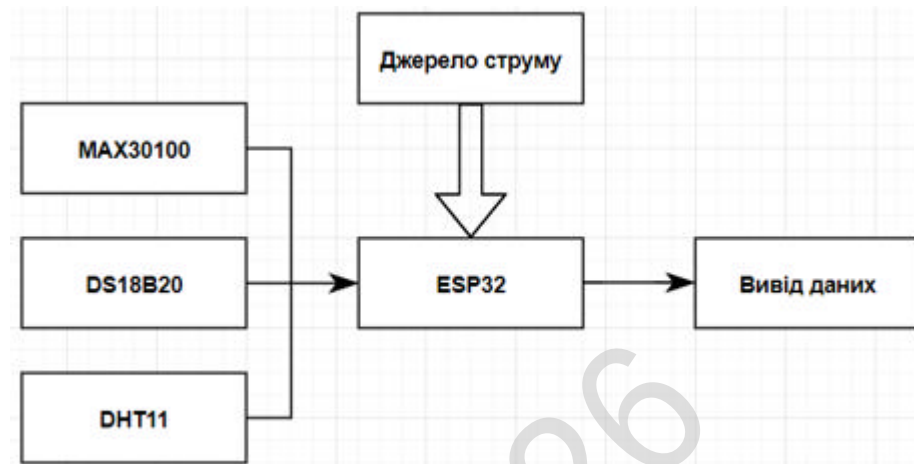
Рисунок 3.9 – Структурна схема роботи пристрою
