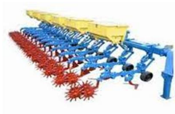
Рис. 3.4. Культиватор УСМК-5,4 (з підживленням рослин)
