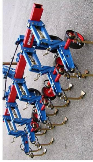
GALILEO – міжрядний просалний культиватор з рамою що складається (Італія)
