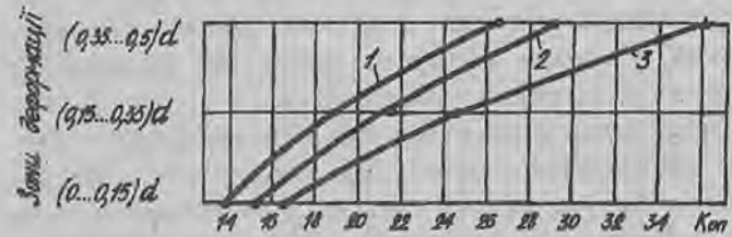
Рис. 4. Зміна коефіцієнта оновлення поверхні K_{оп} по перерізу гранулки \phi 1,5 мм: 1- при пресуванні без розділової фази; 2- розділова фаза - порошок графіту; 3- за розділової фази приймався порошок карбід вольфраму
