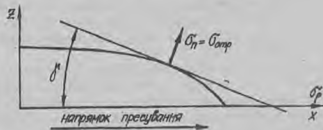
Рис. 3. Схема розподілу нормальних напружень на поверхні деформованої частинки при пресуванні
