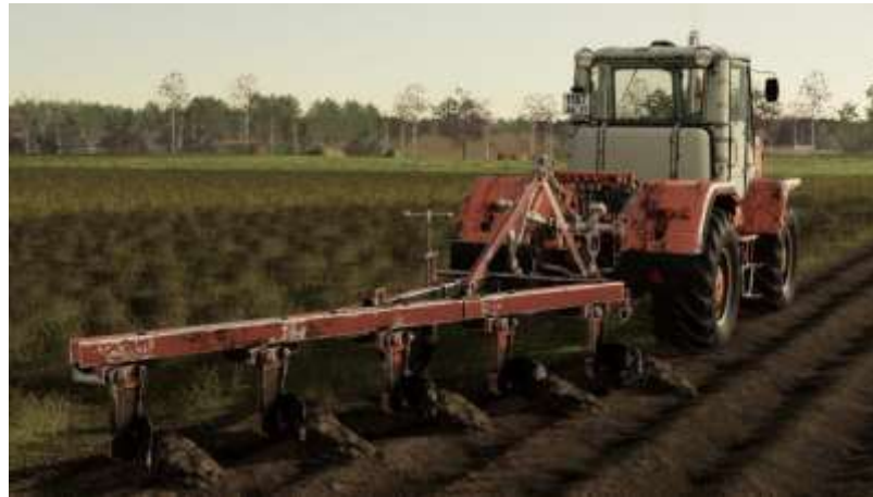
Рис. 1.1. Загальний вид полицевої оранки плугом ПЛН-5-35
