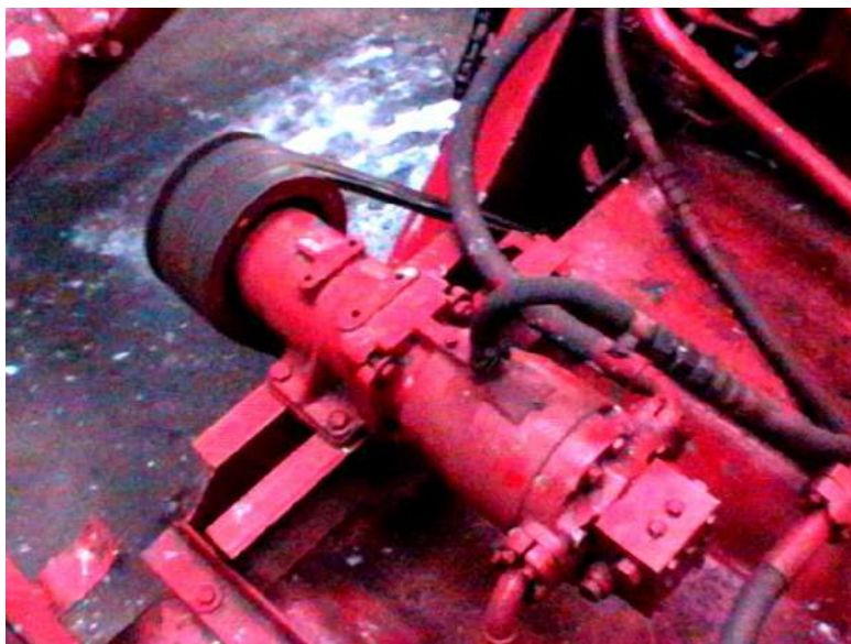
Рисунок 2 - Аксіально-поршневий гідромотор МП-90 для приводу молотарки зернозбирального комбайна
