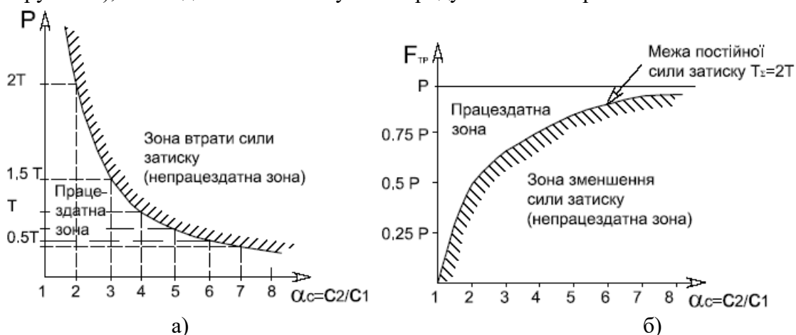
Рисунок 5 – Граничні зони працездатності лещат при дії сили різання на рухому губку: а - випадок I; б - випадок III
