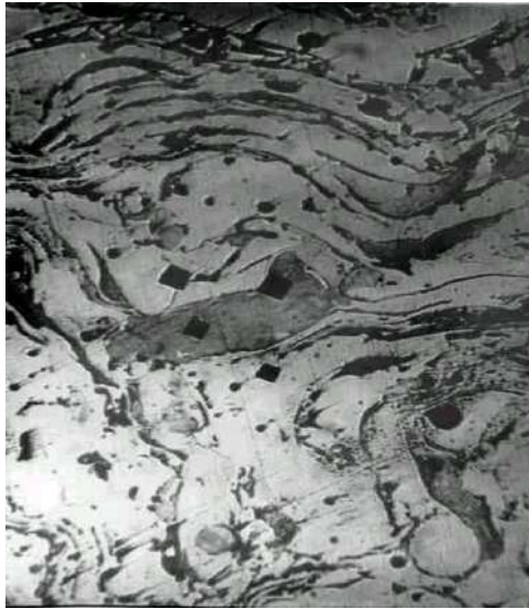
Рисунок 9 - Микроструктура покриття з порошкового дроту
