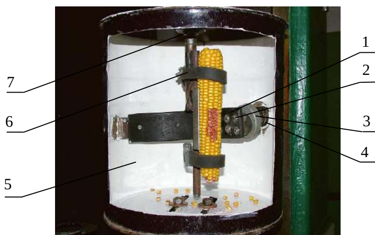
1 - пластина; 2 - шипы; 3 – стакан; 4 – пружина; 5 – корпус; 6 – крепление для початка; 7 – привод
