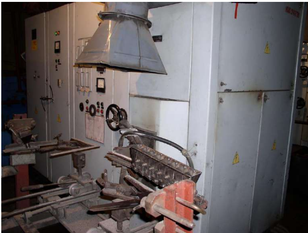
Рисунок 1 – Пристрій для засипки порошкових сумішей, змонтований на установці для індукційного наплавлення культиваторних лап
