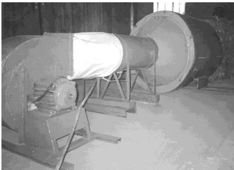
Рисунок 1 – Дослідна установка для сушіння рослинних матеріалів у рулонах
