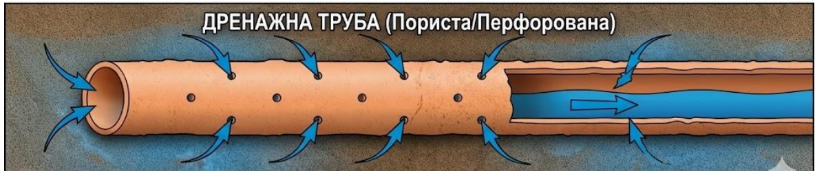
Дренажна труба: збір ґрунтових вод
