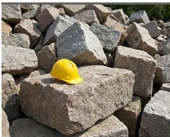
Бут: великі неформатні брили (для фундаментів)
