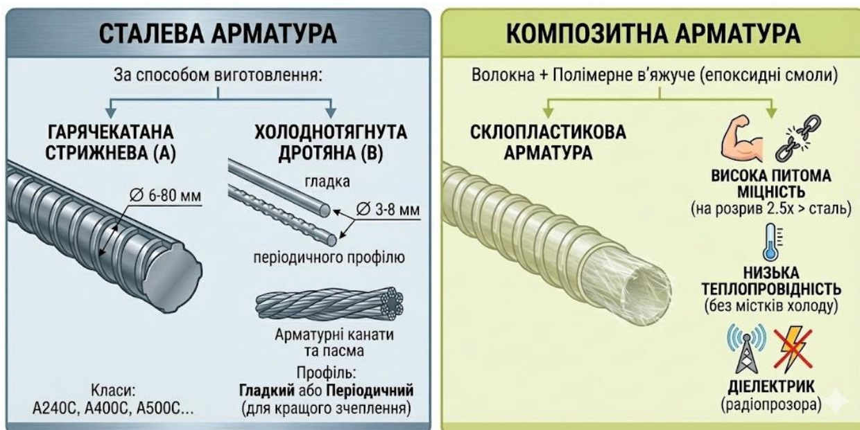
Рисунок 8.2 – Види арматури для залізобетону
