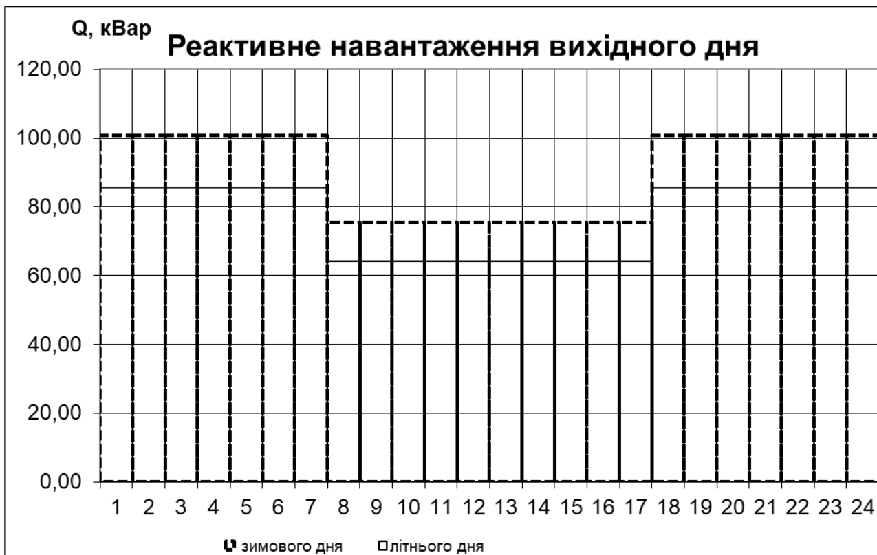
Рис. 2.4. Споживання реактивної потужності в вихідний день.
