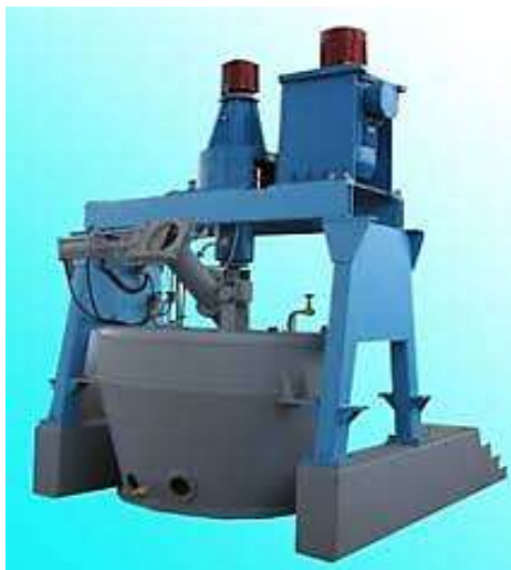
Рисунок 7.1 – Зовнішній вигляд центрифуги ФПН-1251Т-01.
