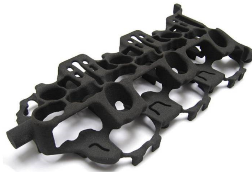
Рисунок 3.8 – Надрукований на 3Д принтері піщаний стержень
