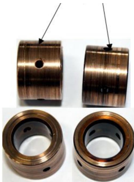
Рисунок 2.8 – Спрацювання втулок радіального підшипника при потраплянні сторонніх частинок в мастило
