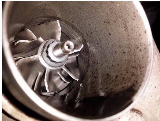
Рисунок 2.4 – Пошкодження країв лопаток колеса об корпус турбокомпресора
