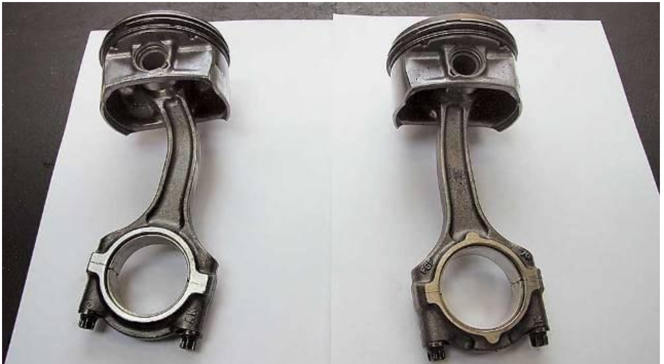
Рис.2.5. Загальний вигляд деформації стрижня шатуна
