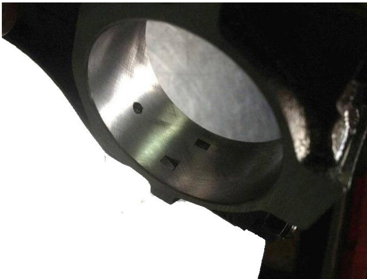
Рис. 2.4. Нижня головка шатуна після ремонту
