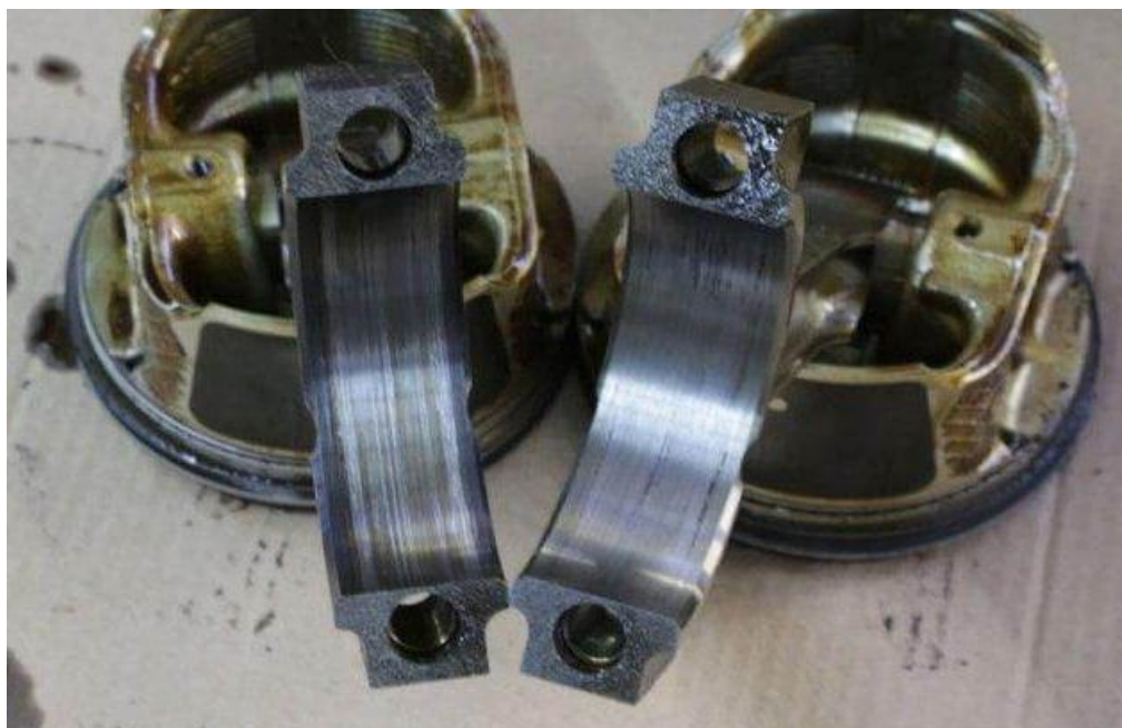
Рис. 2.3. Знос отвору нижньої головки шатуна
