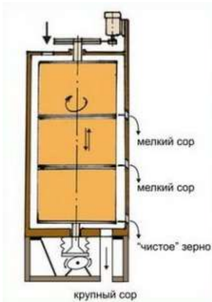
Рис. 3.9. Схема роботи вертикального циліндричного вібровідцентрового решітного сепаратора очисника СВС-25
