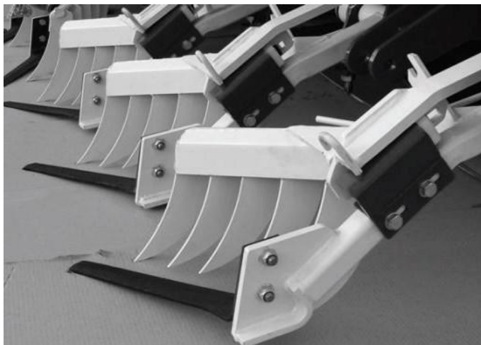
Рис. 3.2. Гичкоріз з пасивним ножом та пасивним полозковим копіром [1].
