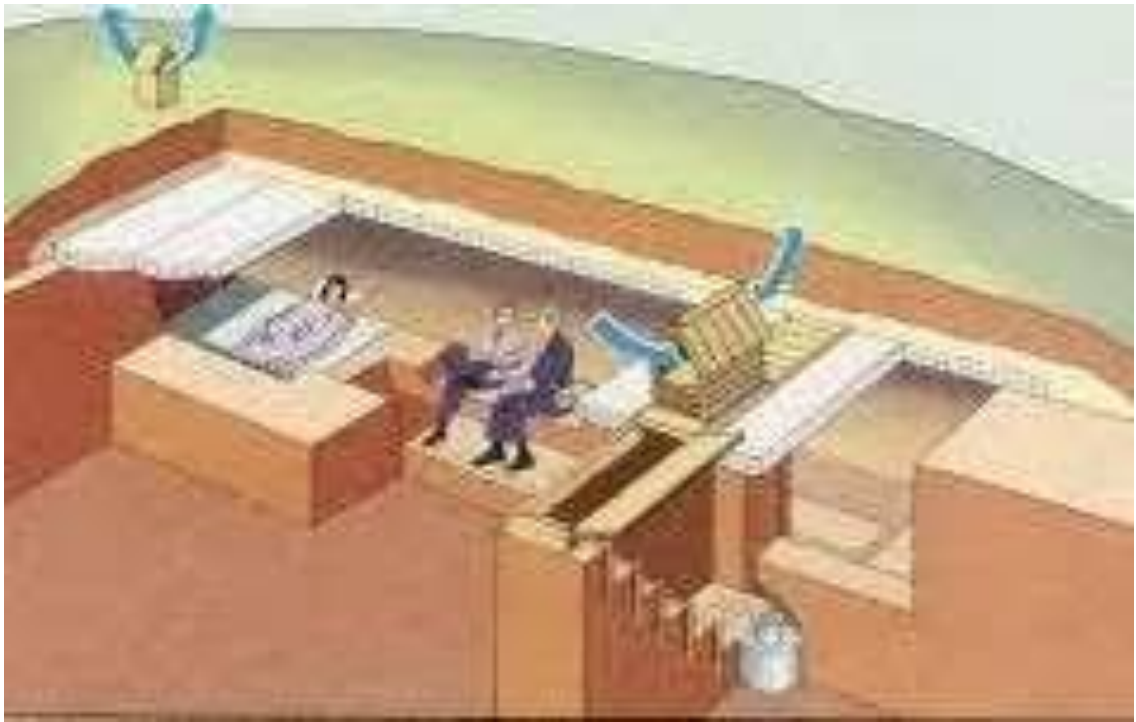
Рис. 5.10. - Укриття з перекриттям залізобетонними плитами
