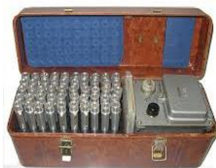
1 - укладальний ящик; 2 - дозиметри ДКП-50-А; 3 - зарядний пристрій ЗД-5 Рис. 1.9. - Комплект індивідуальних дозиметрів ДП-22В
