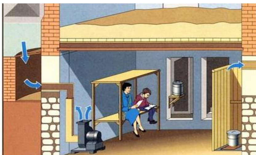
Рис. 5.9. - Пристосування підвалу висотних будівель під захисну споруду
